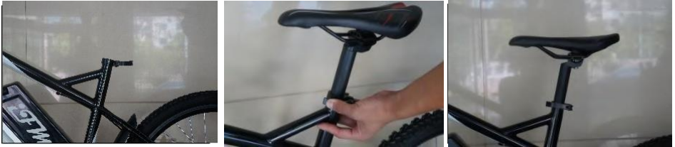
Figura 5- Montaggio e regolazione della sella.
