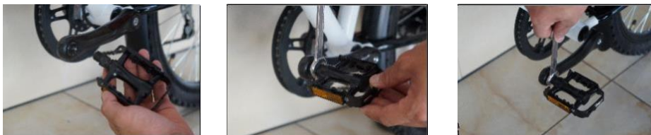
Figura 3 - Montaggio dei pedali.
