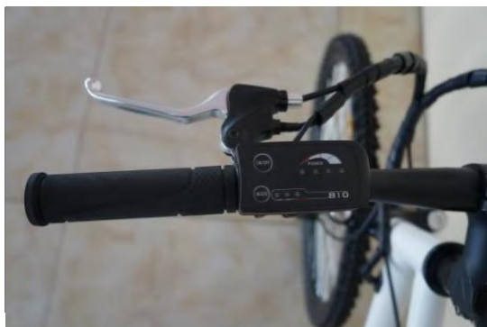
Figura 14 - Visualizzatore del livello di carica della batteria.
