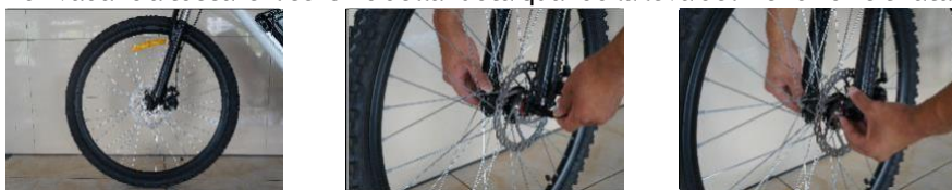
Figura 2 - Montaggio della ruota anteriore.
