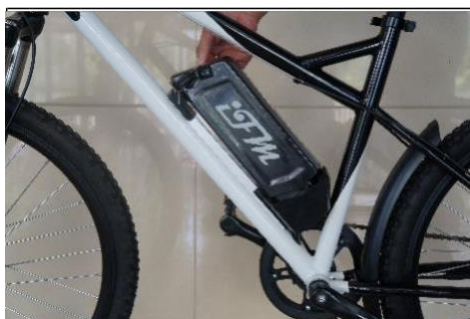
Figura 13- Estrazione della batteria dalla propria sede.
