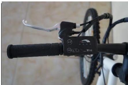
Figura 9- Led visualizzazione carica batteria e accensione.
