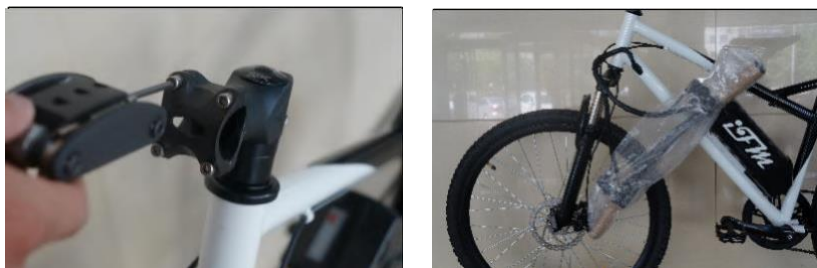
Figura 4- Montaggio del manubrio della bicicletta.
